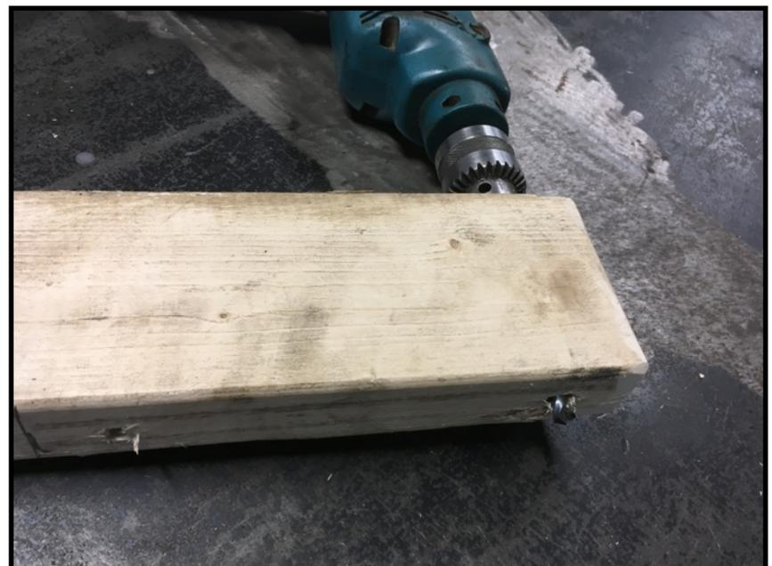
L'ensemble comporte une plaque de protection du 2 par 4, celle-ci sert à empêcher que le 2 par 4 ne fende suite à une force exercée sur la base.
