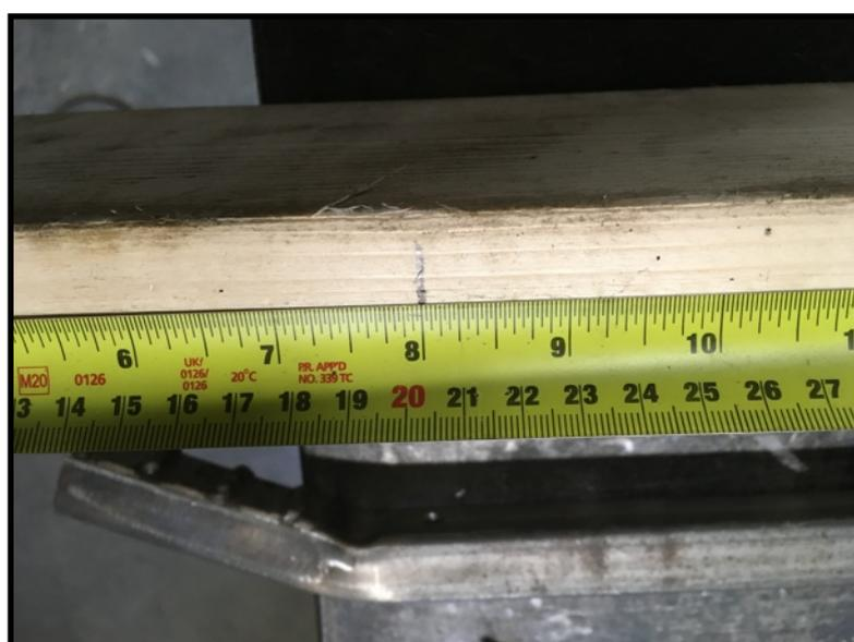
Installez la poignée vis à vis la marque de 8" centré sur le 2 par 4 avec une serre.
